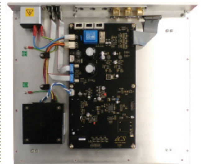
Il cuore del Rossini Master Clock è una scheda asservita a conferire la più alta stabilità all'oscillatore.
